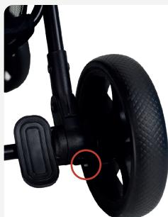
• Para colocar a roda traseira, encaixe-as pressionando a trava rápida da roda. Para realizar a retirada da roda, deve-se pressionar a trava e puxar a roda para fora.
