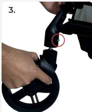
• Pressione a trava até a extremidade para inserir a roda dianteira. Monte as rodas dianteiras de baixo para cima. Para realizar a retirada da roda, deve-se pressionar a trava e puxar a roda para baixo.
